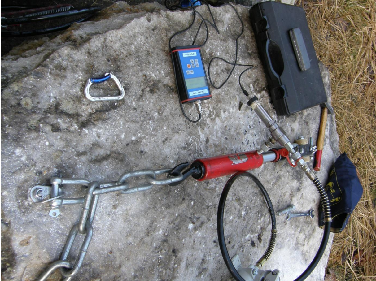
Hydraulické měřicí zařízení ČHS instalované mezi dvěma kotvami.
