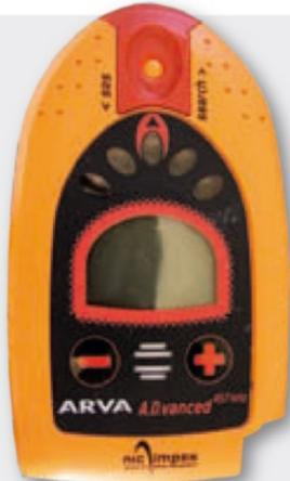
Zařízení s dobrým dosahem, které odvede dobrou práci při vyhledání zasypaného. Při přesném dohledání zasypaného nacházejícího se ve větší hloubce vykazuje značnou odchylku díky technologii dvou antén. V případě záchrany více zasypaných je nejlepší použít metodu tří kruhů. Funkce pro přímý postup není k dispozici.
